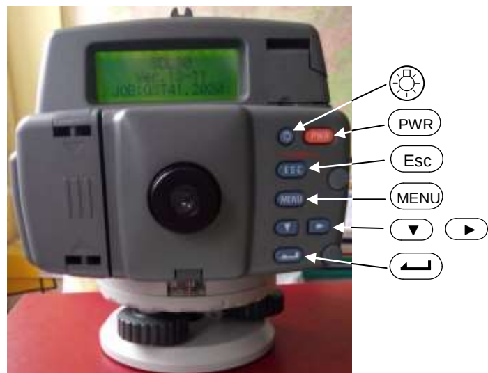
Рис. 2.3. Клавіатура нівеліра SDL30
