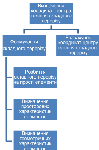
Рис. 4.1 «Дерево функцій» визначення центра тяжіння складного перерізу Аналіз простих елементів, з яких може складатися переріз
