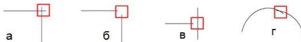
Рис. 1.5. Неправильне з'єднання відрізків, які треба усунути в AutoCAD перед перенесенням в ПК Midas GTS NX
