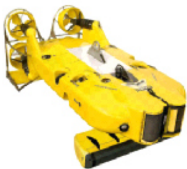
Рис. 3. Підводний апарат з рушійним комплексом, який організовано за чотирьохвальною схемою
