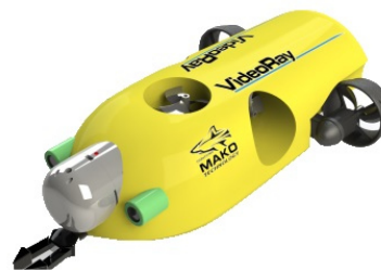
Рис. 6. Підводний апарат, підрулювальний комплекс якого організований за двохвальною просторовою схемою
