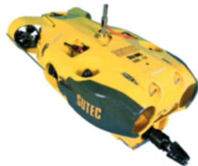
Рис. 2. Підводний апарат з рушійним комплексом, який організовано за двохвальною схемою
