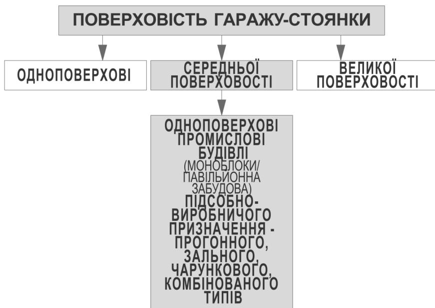
**Рис.2. Схема-підбір промислових корпусів для перепрофілювання у гаражі-стоянки за поверховістю**
