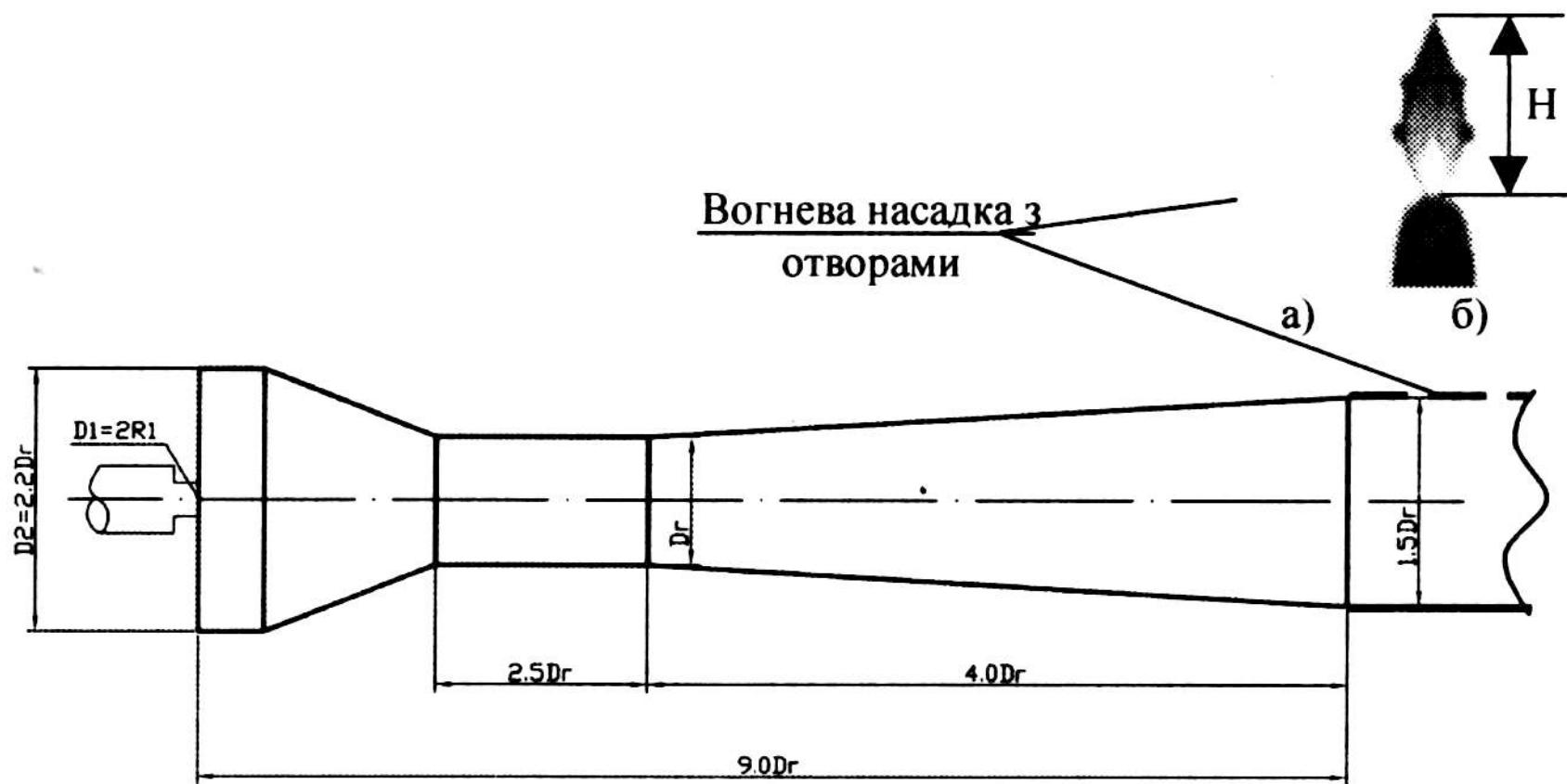
**Рис. 1. Схема атмосферного пальника з  $\alpha' < 1$**
