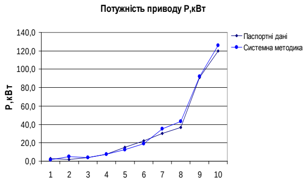
Рис. 3. Результати розрахунку основних параметрів (діаметр чаші, частота обертання ротора, потужність) та порівняння з паспортними даними множини змішувачів.
