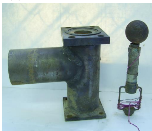
Рисунок 2. Розчинонасос із установленими датчиками для запису параметрів ходу клапанів:
