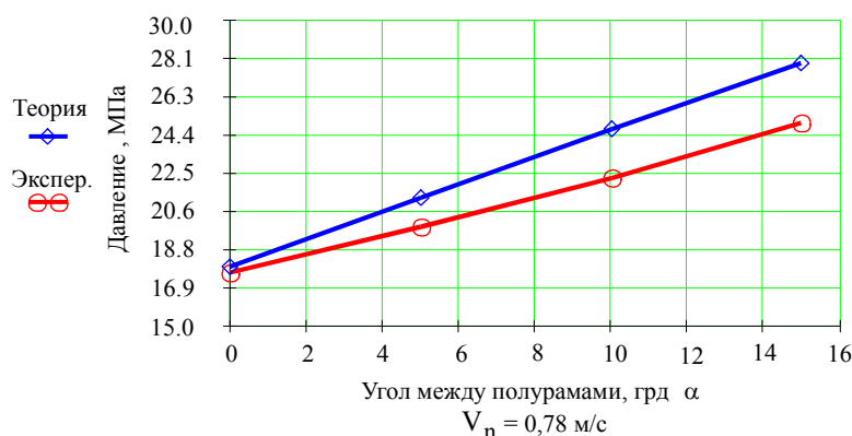
Рис.4. Соотношения экспериментальных и теоретических значений давления в гидроприводе механизма рулевого управления
