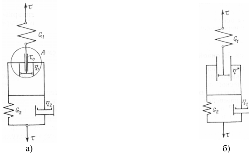
Рис. 8. Реологічна модель Шофілда – Скотта - Блера
