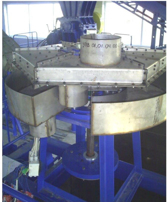
Рис. 11. Тримасовий вібраційний сепаратор з електромагнітним приводом в складі автоматичної технологічної лінії
