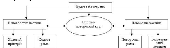
Рис. 1. Структурна схема автокрана
