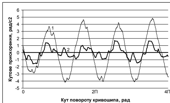
Рис. 3. Графіки зміни кутового прискорення привідного вала установки в холостому режимі з одним формувальним візком (1) та з двома візками (2)
