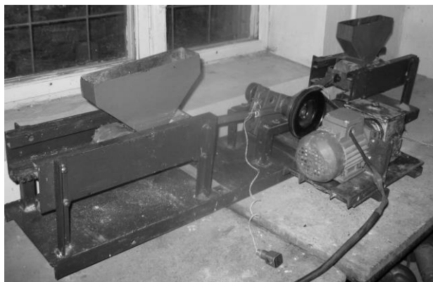
Рис. 1. Фізична модель роликової формувальної установки з рекупераційним приводом
