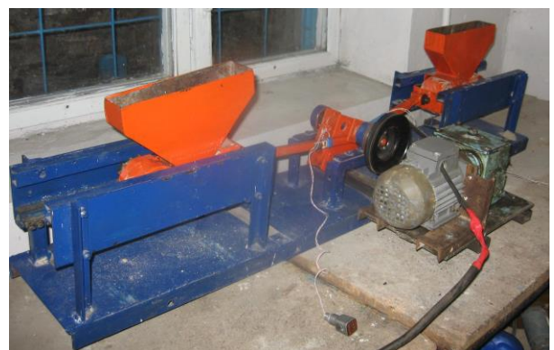
Рис. 3. Фізична модель роликів формувальної установки з рекуперативним приводом
