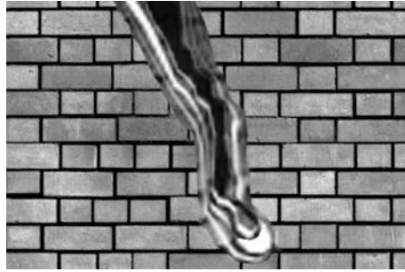
Рис. 6 Представлення розподілу градієнта вздовж дефекта
