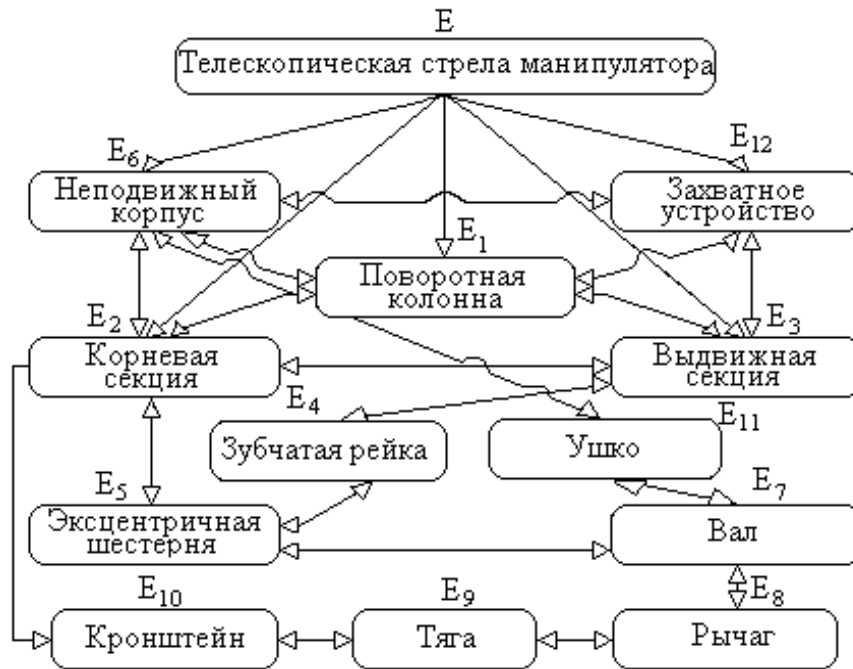
Рис.2. Структура-граф функционального взаимодействия между элементами манипулятора с телескопируемой стрелой.
