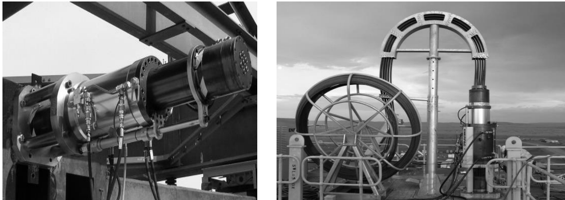
Рисунок 2. Загальний вигляд: а - гідравлічного пристрою EZ600-40 фірми FAGIOLI вантажо-підйомністю 690 т (при висоті піднімання Н= 5,49 м. і 250 т при – Н=12,19 м); б – технічні розміри.
