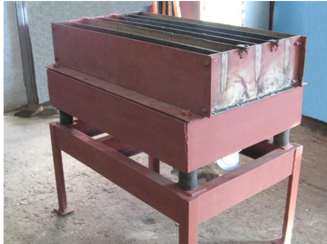
Рисунок 3. Віброустановка для формування поребриків.
