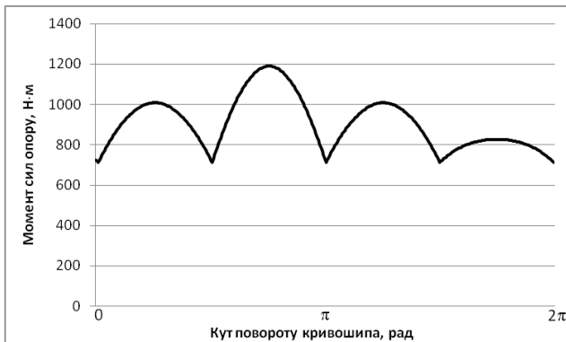
Рисунок 5. Графік зміни зведеного моменту сил опору на переміщення формувальних візків в залежності від кута повороту кривошипа.
