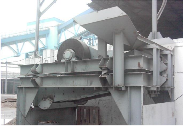
Рисунок 3. Дебалансний вал вібраційного грохота.
