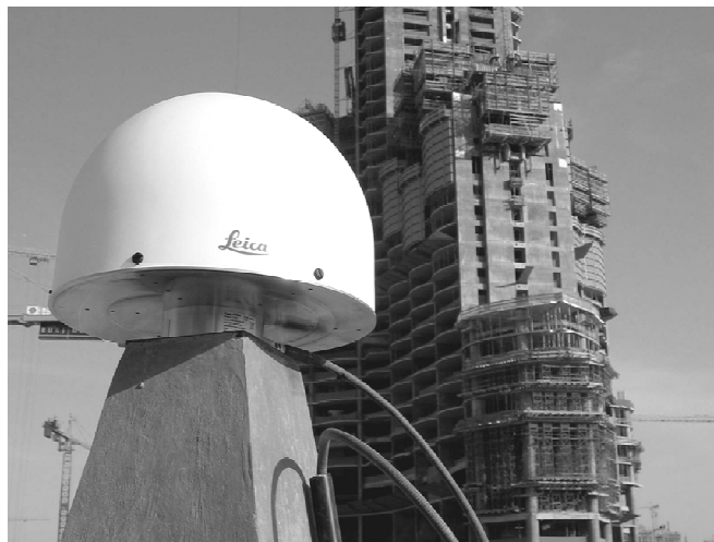
Рис. 3. Базова станція вихідної геодезичної мережі будівлі
