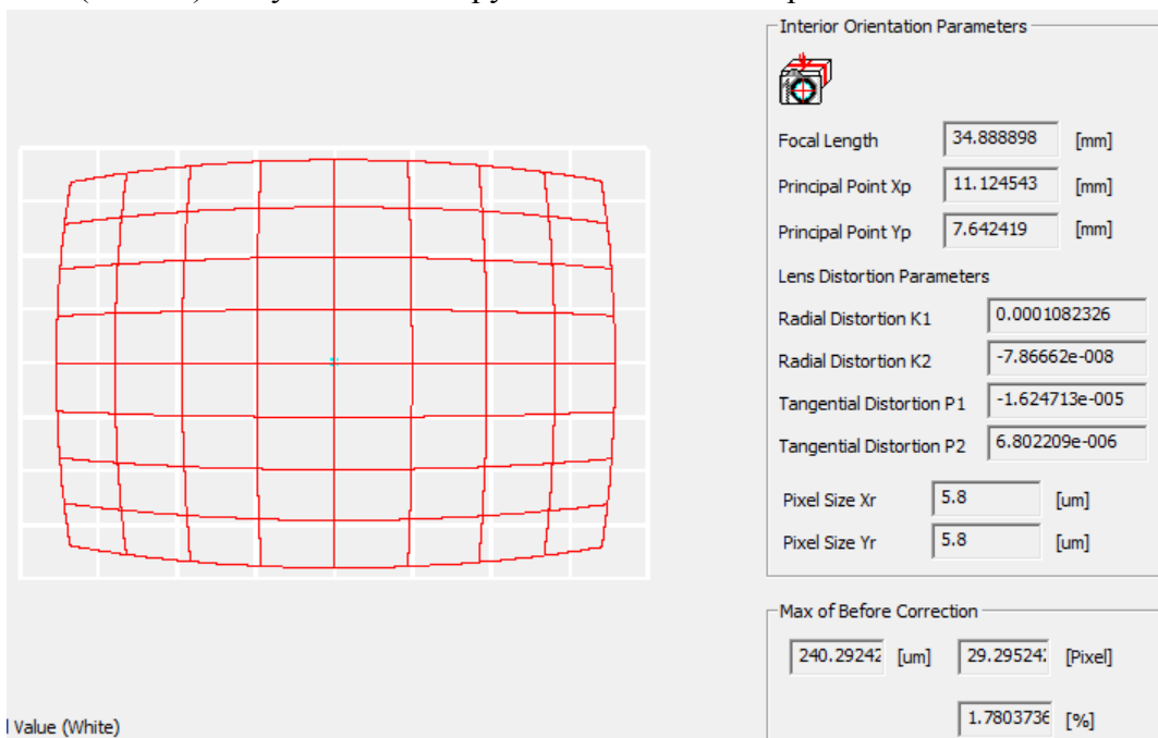
Рис. 2. Параметри калібрування для камери Nikon D200 в програмі 3D Image Master
