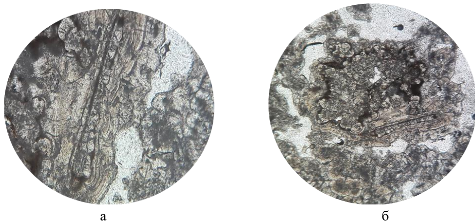
Рис. 5 – Травертин під мікроскопом: а – мікросаруватий; б – концентрично-зональний з великою кількістю пустот. Прозорий шліф, ніколі паралельні, збільшення 25^{\times}
