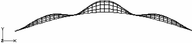
Рис. 3. Перша згинальна форма коливань двотаврової балки ( \omega_{1u}=451.798 рад/с)
