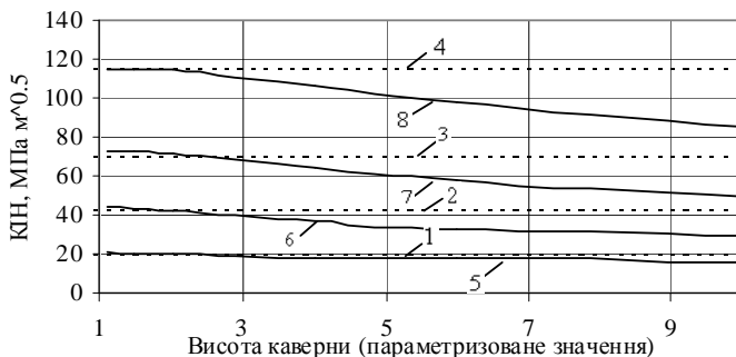
Рис. 9. Графіки розподілу КІН; внутрішня тріщина; задача другого варіанту: 1 - розв'язок [10] для a/t=0.1 , 2 - розв'язок [10] для a/t=0.3 , 3 - розв'язок [10] для a/t=0.5 , 4 - розв'язок [10] для a/t=0.7 , 5 - чисельний розв'язок для a/t=0.1 , 6 - чисельний розв'язок для a/t=0.3 , 7 - чисельний розв'язок для a/t=0.5 , 8 - чисельний розв'язок для a/t=0.7
