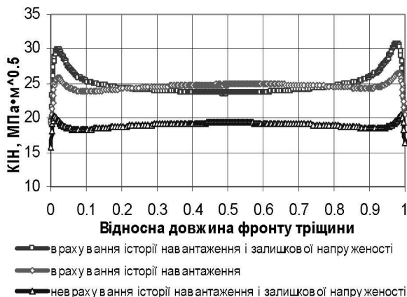
Рис. 3. Вплив історії навантаження на визначення КІН вздовж фронту для поверхневої колової тріщини у вузлі приварки для режиму нормальних умов експлуатації
