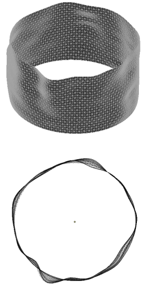
Рис. 1. Модель оболонки з візуалізацією реальних відхилень твірних в масштабі 1:20
