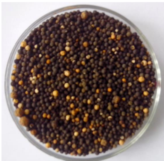
Рис. 1. Полімерні гранули фільтруючого завантаження, покриті характерною темно-коричнево-чорною плівкою, вірогідно з вищих оксидів марганцю, і жовто-рудю плівкою з \text{Fe}_2\text{O}_3 , що утворилася при зневодненні \text{Fe}(\text{OH})_3 .
