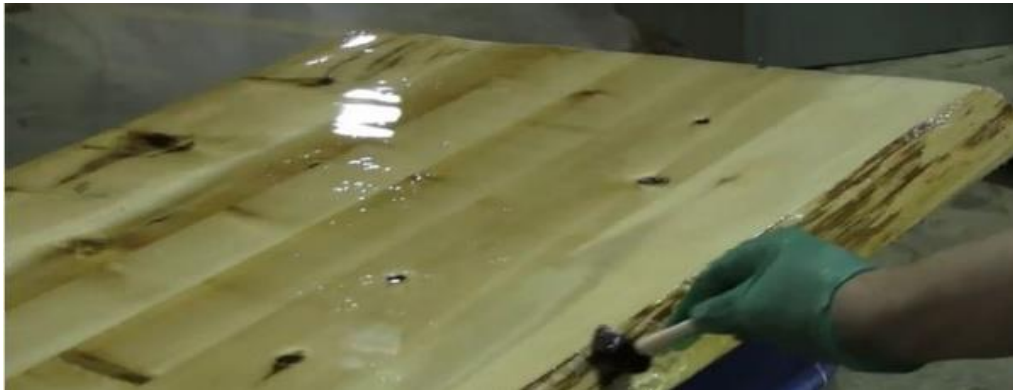
Рис. 1. Обробка деревини рідким натрієвим склом.
