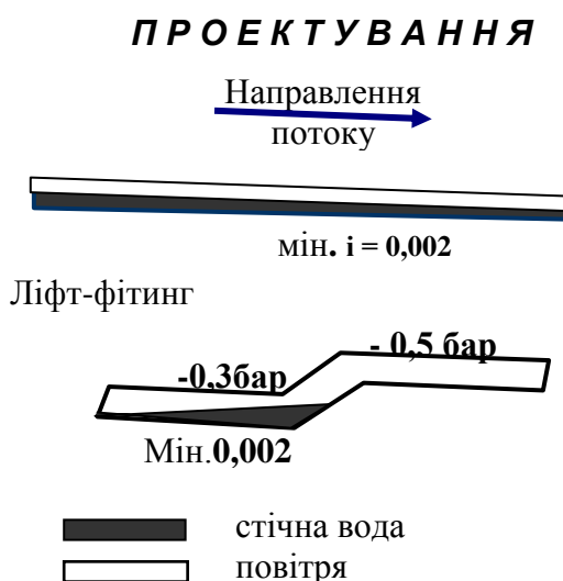
Рис. 4. Пристрій ліфт-фітингу на трубопроводі
