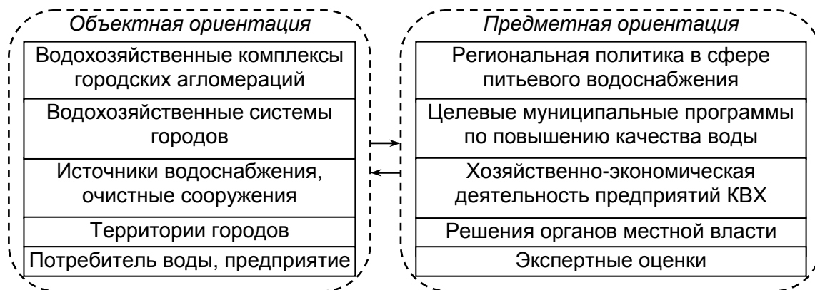
Рис. 4. Сфера применения СВМ в централизованном питьевом водоснабжении
