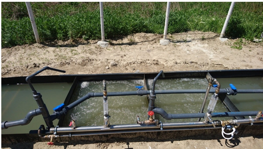
Рис. 1. Экспериментальная установка. Справа налево: аноксичный биореактор, два аэробных биореактора, тонкослойный отстойник
