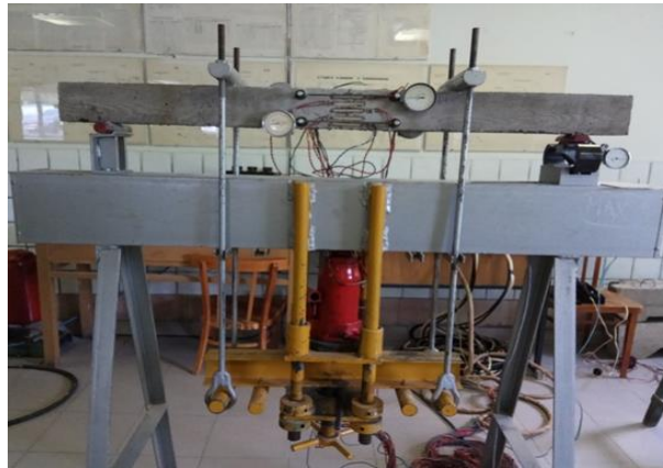
Рис. 3. Стенд для випробування дослідних балок.
