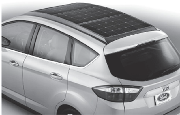
Рисунок 1. Концепт електромобіля, в конструкцію якого інтегровані геліоколектори
