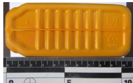
Рис. 5. Маркувальні позначення, нанесені на дно каністри
