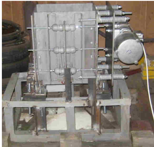
Рис. 7. Експериментальна установка вібраційної шоквої дробарки
