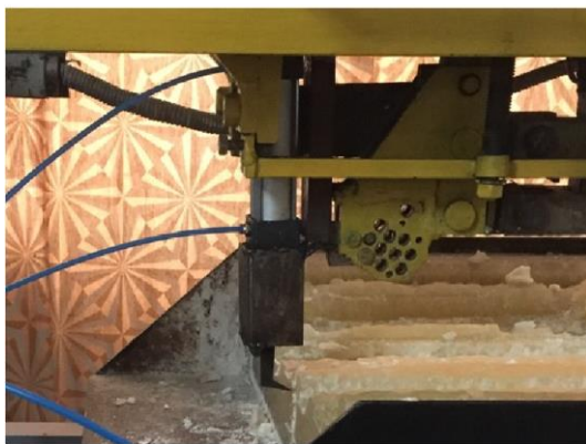
Рис. 4. Фото станда для дослідження процесу заглиблення виглиблення зуба розпушника: 1 – блок живлення; 2 – кабель живлення; 3 – шестиканальний підсилювач та мікроконтролерний блок керування; 4 – кабель передачі сигналу; 5 – персональний комп'ютер; 6 – рукоят
