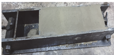
Рис. 1 – Виготовлення зразків грунтобетону 70x70x70 мм та загальний вигляд
