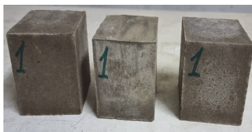
Рис. 1 – Виготовлення зразків грунтобетону 70x70x70 мм та загальний вигляд
