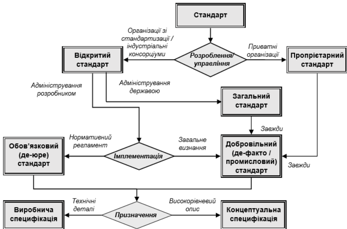
Рис. 1.2. Логічна схема класифікації стандартів за процедурами розроблення й адміністрування та регламентами використання
