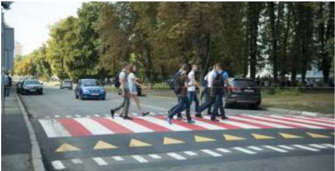
Рис. 8.10. Приклад влаштування піднесеного пішохідного переходу
