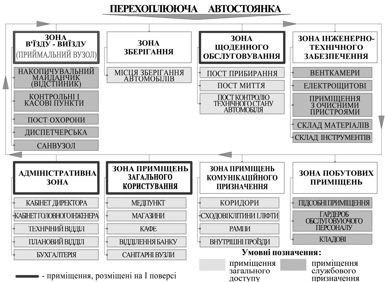
Рис. 3. Схема функціонального зонування перехоплюючої автостоянки
