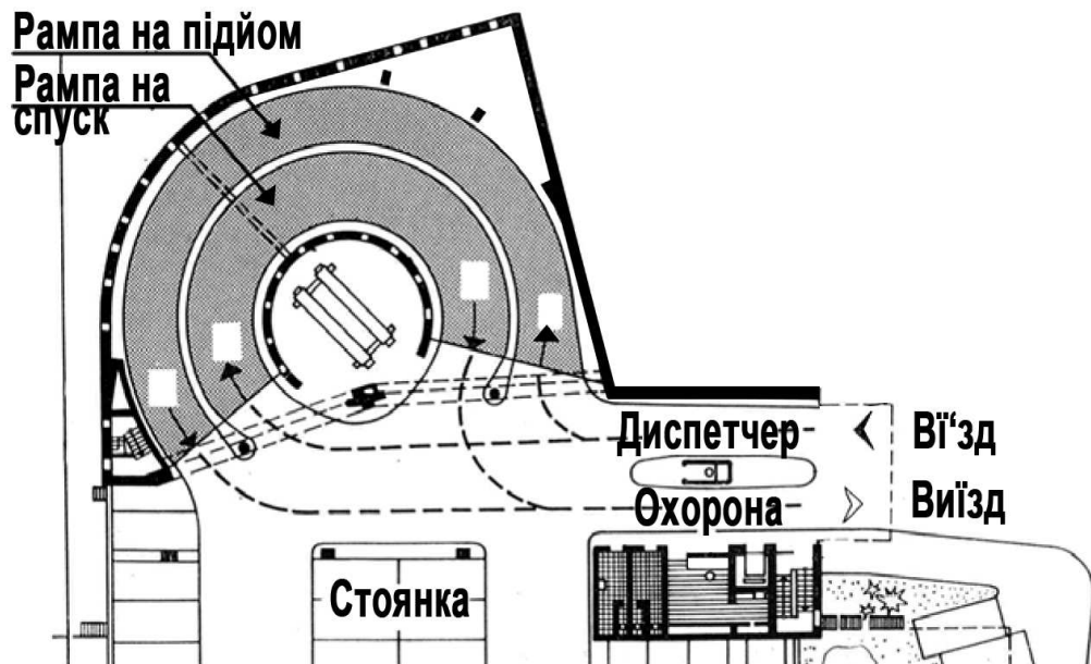
Рис. 9. Схема організація в'їзду і виїзду у перехоплюючій автостоянці
