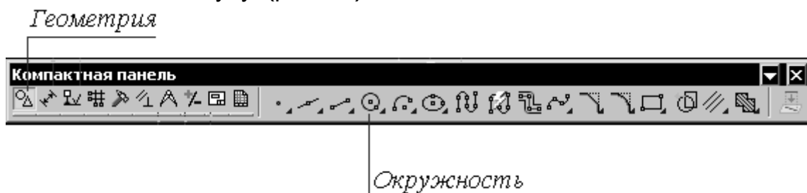
Рис. 10. Системна компактна панель ескізів та графічних документів
