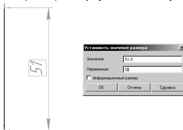
Рис. 48. Призначення параметричного розміру об'єкта
