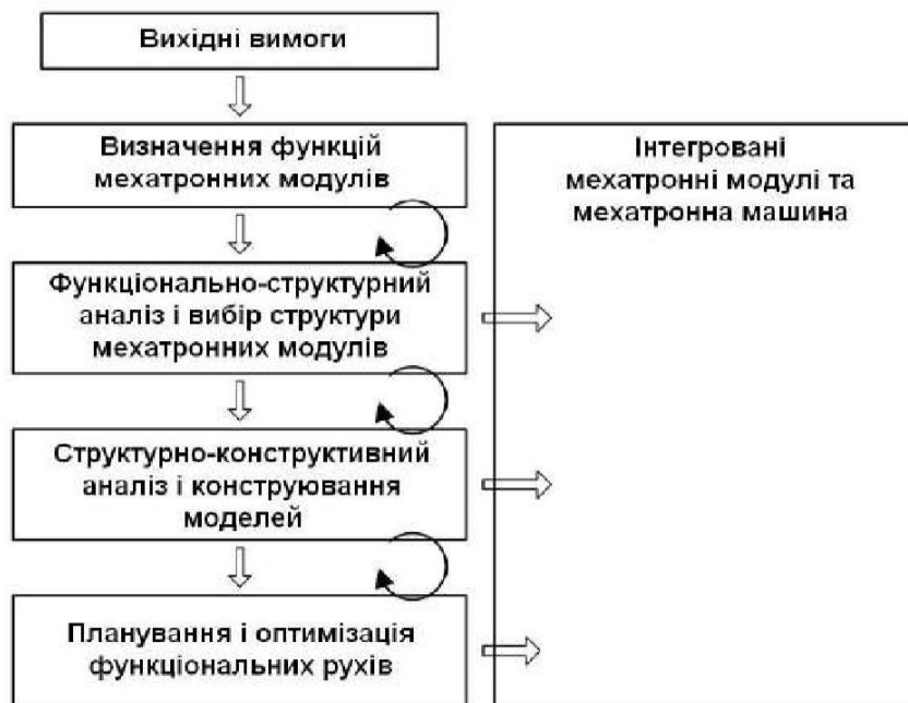
Рис. 3.5. Процедура проєктування інтегрованих мехатронних машин
