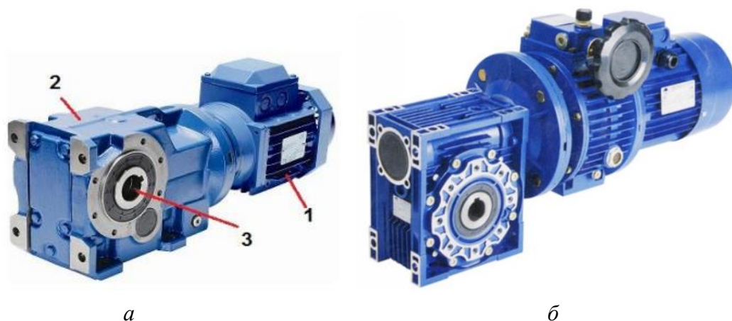
Рис. 2.12. Мотор-редуктор: а – циліндричний; б – циліндричний з варіатором; 1 – електричний двигун; 2 – редуктор; 3 – вихідний вал редуктора
