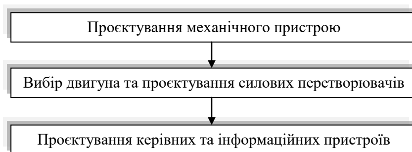
Рис. 3.3. Традиційний алгоритм проєктування
