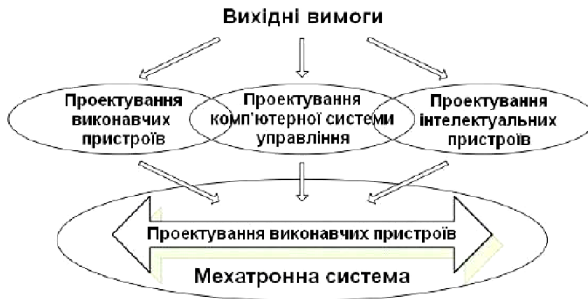
Рис. 3.4. Алгоритм паралельного проектування мехатронних систем
