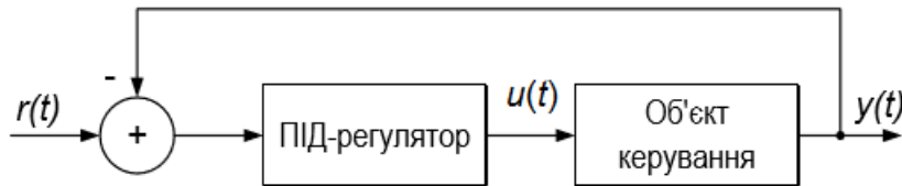
Рис. 8.1. Структура системи із застосуванням ПД-регулятора
