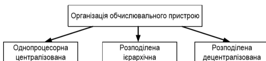
Рис. 6.1. Способи організації обчислювального пристрою системи комп'ютерного керування
