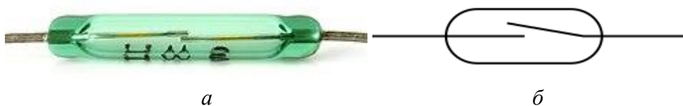
Рис. 5.19. Геркон: а – вигляд; б – схематичне позначення
