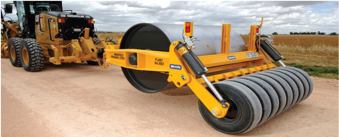
Рис. 4.25. Ущільнення ґрунту пневмогладковальцевим котком eCombi
