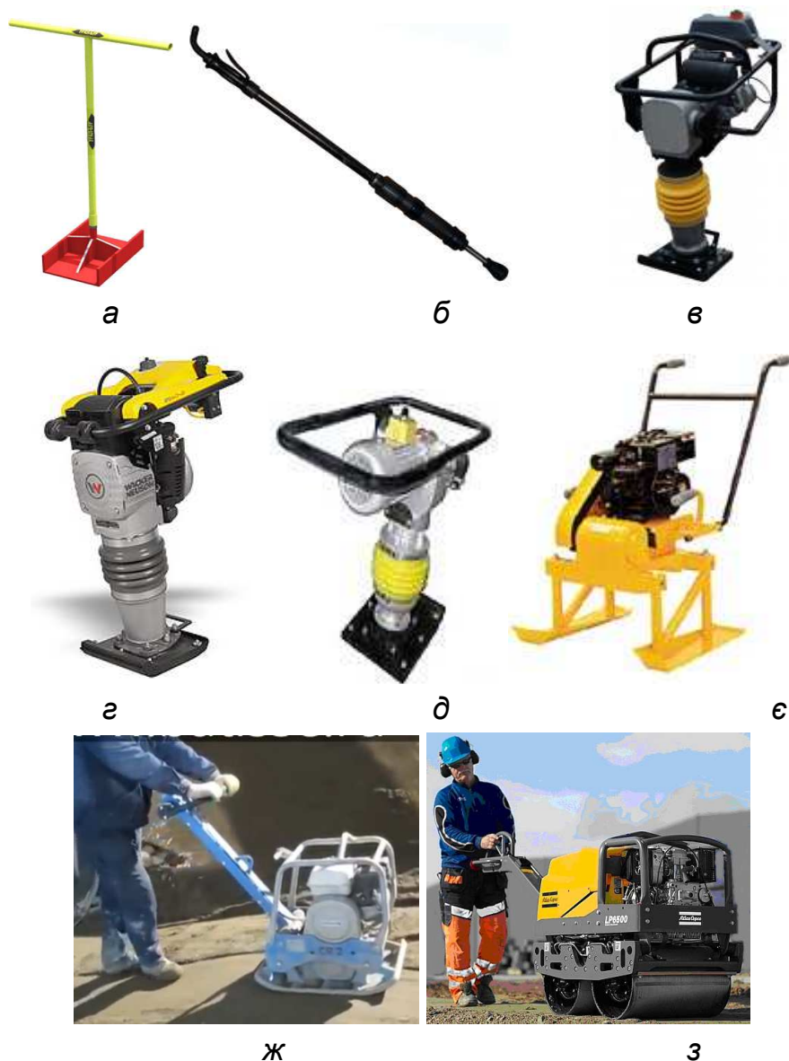
Рис. 5.2. Інструменти і механізоване обладнання для ущільнення ґрунту в обмеженому просторі: а – трамбівка ручна; б – трамбівка з пневмоприводом; в – трамбівка вібраційна бензинова ручна; г – вібротрамбівка дизельна ручна; д – трамбівка вібраційна електрична ручна; е – спеціалізована механічна вібротрамбівка; ж – віброплита малогабаритна механізована; з – мінікоток з виносним керуванням
