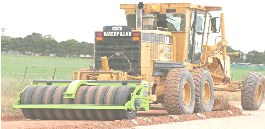
Рис. 4.3. Укочування насипного шару одноосним причіпним котком
