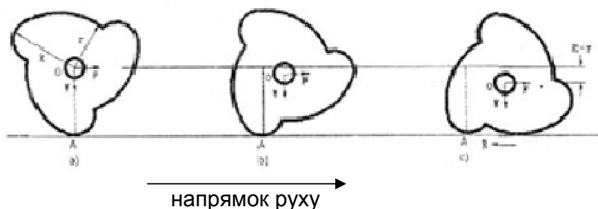
Рис. 4.18. Принцип роботи нециліндричного тригранного котка
