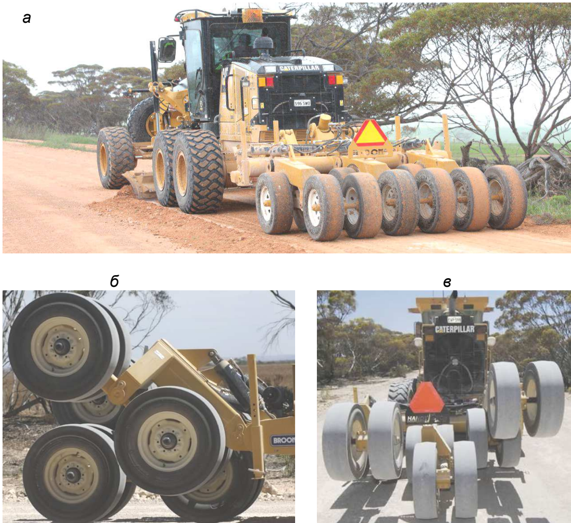
Рис. 4.4. Причіпний пневмоколісний коток фірми BROONS: а – пошарове укочування; б, в – вид збоку і зверху
