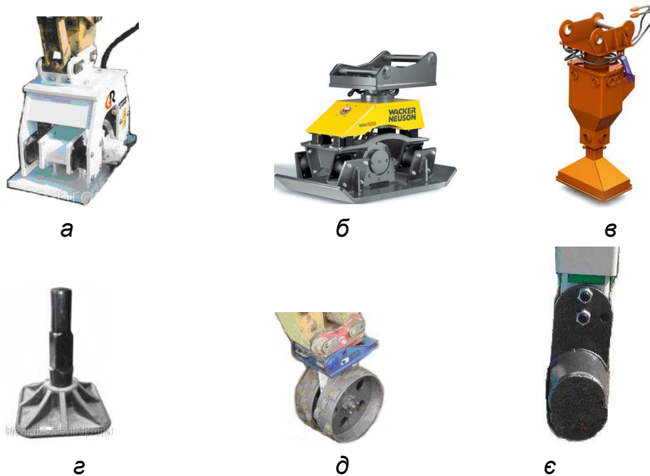
Рис. 5.4. Навісне обладнання на стрілу екскаватора: а – вібротрамбівка; б – віброплита; в – інерційна гідравлічна трамбівка; г – трамбуєча насадка на гідромолот; д – ущільнювальне колесо Stehr; є – траншейна трамбівка
