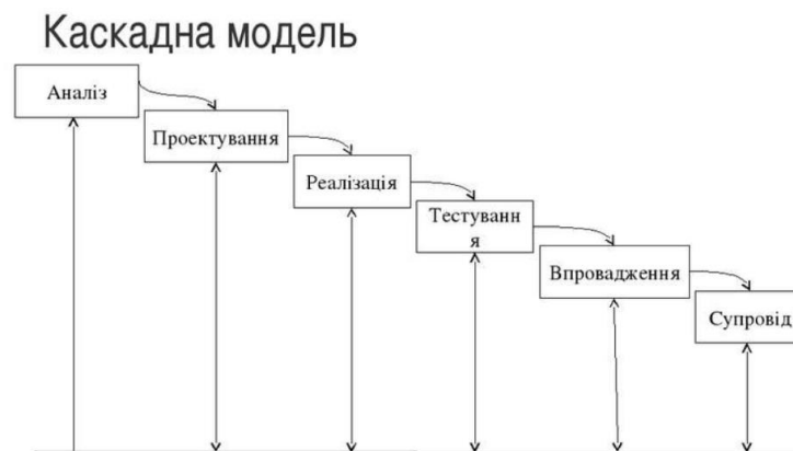
Рис. 5.2. Структурна схема каскадної моделі розробки ІС
