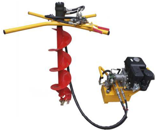
Рис. 10. Ручний буровий механізм з гідравлічним приводом
