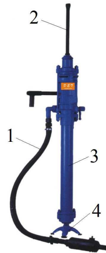
Рис. 2. Телескопічний перфоратор: 1 – повітряний шланг; 2 – буровий інструмент; 3 – перфоратор; 4 – стійка
