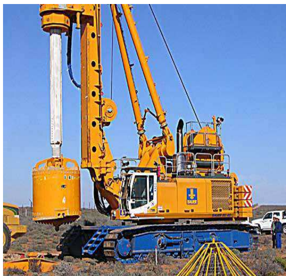
Рис. 26. Загальний вигляд бурової установки із буровим ковшем
