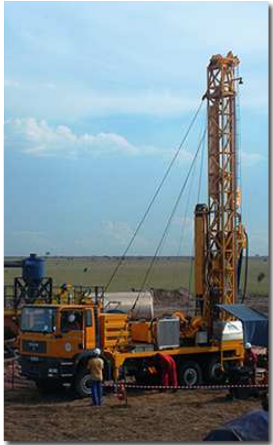
Рис. 16. Бурова установка PRAKLA RB 50 на шасі автомобіля:
