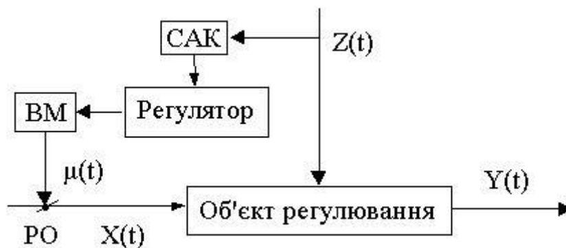
Рис. 9.3. Функціональна схем керування за збуренням: РО – регулювальний орган; САК – система автоматичного контролю вихідного параметра; ВМ – виконавчий механізм; \mu(t) – керівний вплив; Z(t) – збурювальний вплив; X(t) – вхідний параметр; Y(t) – значення вихідного параметра
