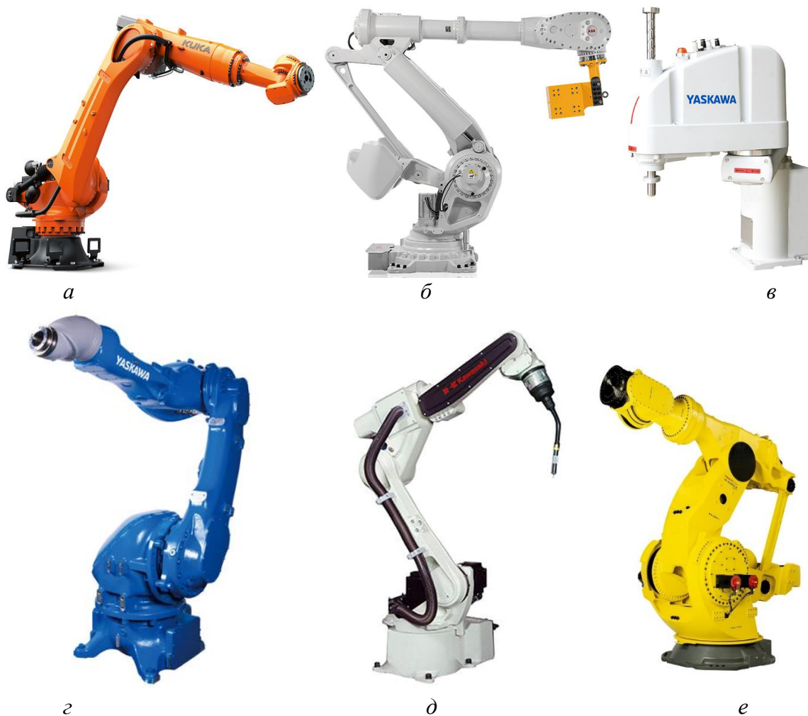
Рис. 1.1. Промислові роботи: а – універсальний маніпулятор KR Quantec 210 R2700 (KUKA); б – пакетувальний маніпулятор IRB8700 (ABB); в – високоточний складальний SCARA маніпулятор MYS450F (YASKAWA); г – зварювальний робот BA006N (KAWASAKI); д – фарбувальний маніпулятор MPX2600 (YASKAWA); е – вантажний маніпулятор M-2000iA/2300 (FANUC)
