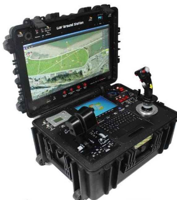
Рис. 5.14. Види радіопередавачів: a – комбінований передавач DJI Mavic з під'єднанням до смартфона; б – 12-и канальний Radiolink AT10 II радіопередавач малого радіуса дії; в – спеціалізована станція-передавач з FPV UAV
