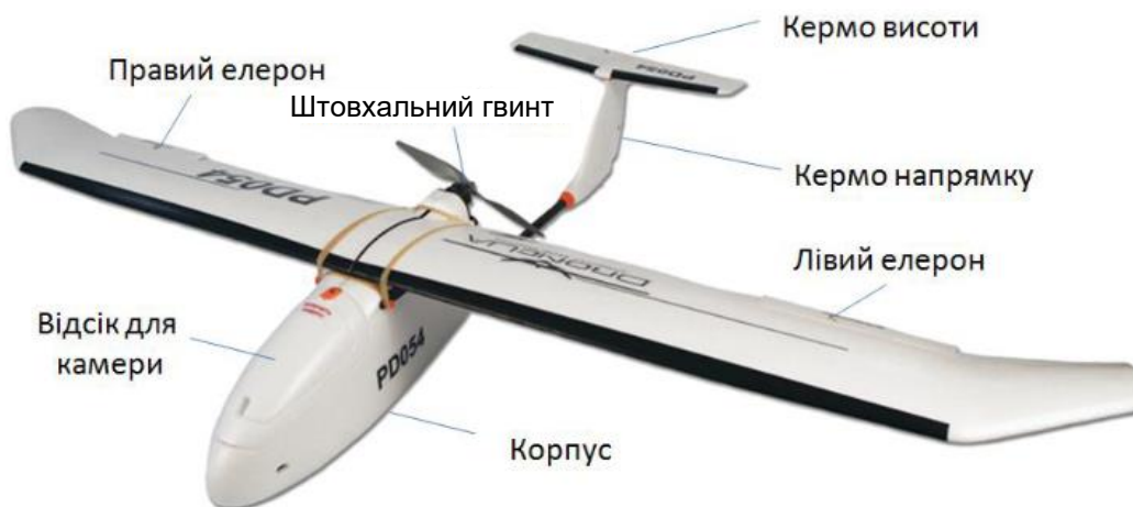
Рис. 2.11. Будова та основні характеристики БПЛА PD 1900: крейсерська швидкість – 50 км/год; розмах крила – 190 см; тривалість польоту – 100 хв; опір вітру – до 27 км/год; дальність трансляції сигналу – до 40 км
