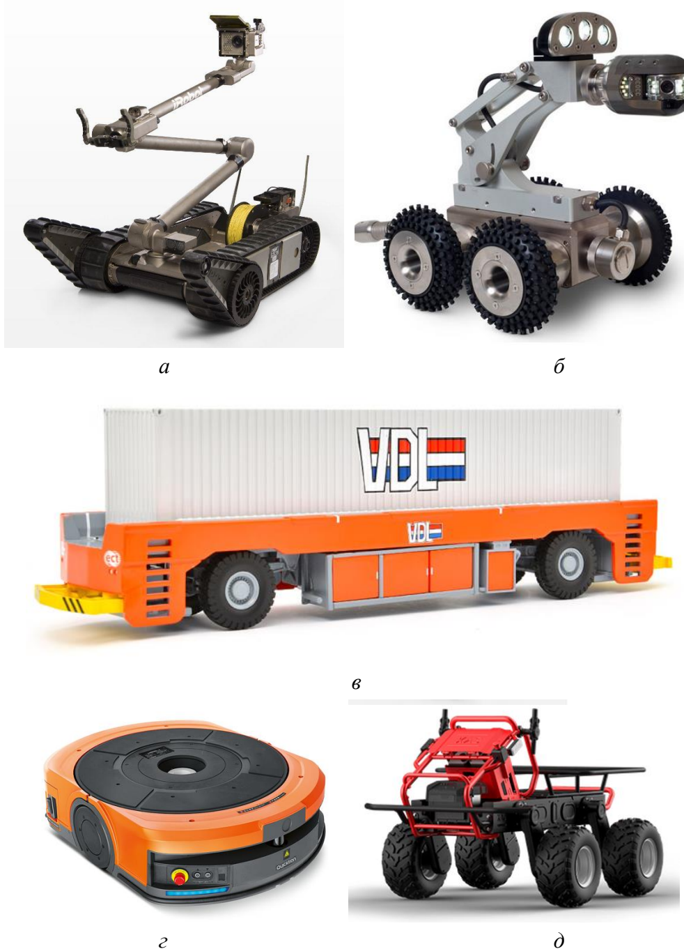
Рис. 3.1 – Транспортні роботи: а – система iRobot Packbot 510, яка застосовувалася на атомній станції Фукусима; б – траулер для обстеження трубопроводів; в – AGV (Automated Guided Vehicle), який застосовують в порту Роттердам для перевезення контейнерів; г – платформа QUICKTRON, застосовувана для автоматизації складу Amazon; д – дрон XAG R150 для сільського господарства
