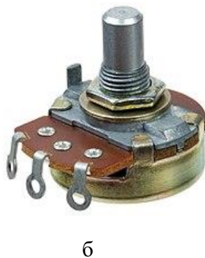
Рис. 4.13. Схема ділильника напруги (а) та вигляд змінного резистора (потенціометра) (б)
