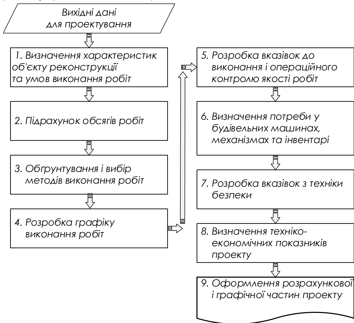
Рис. 1. Загальна схема методики проектування технології виконання будівельно-монтажних робіт у курсовому проекті
