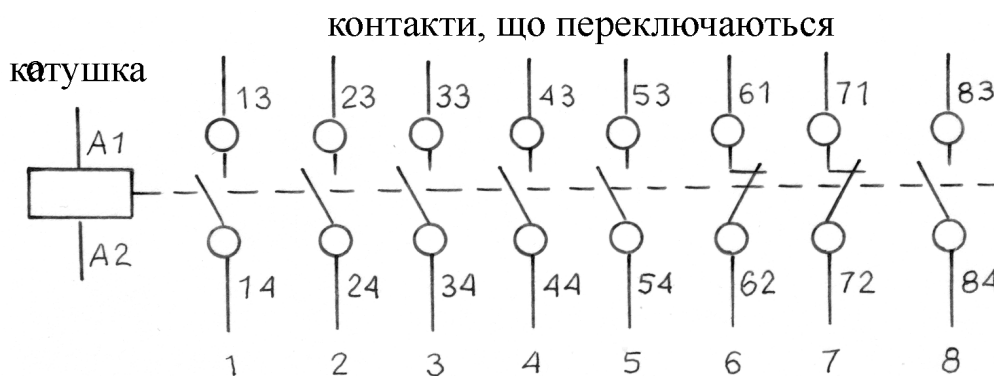
Рис. 3.14. Умовне позначення і позначення виводів контактів реле
