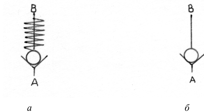
Рис. 4.7. Зворотний клапан: а – підпружинений; б – розвантажений
