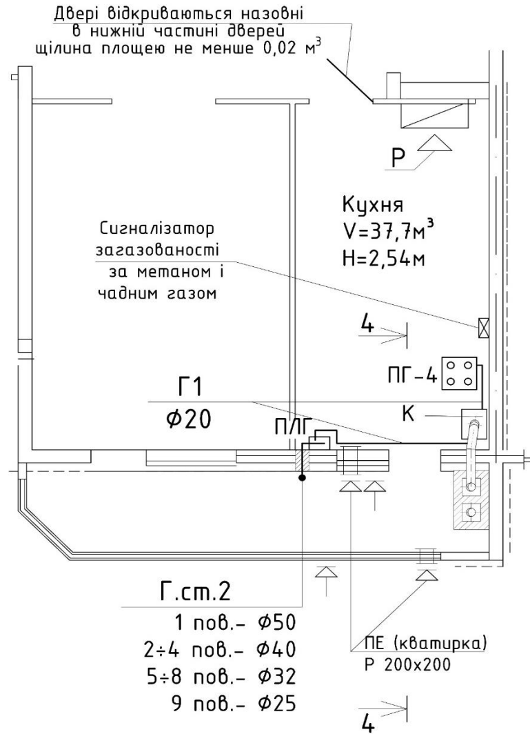
Рис. 41. План квартири і розріз з елементами системи газопостачання і димовидалення (подвійний канал димохідної системи)
