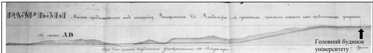
Фото 5. Профіль поверхні ґрунту перед західним фасадом головної будівлі Університету. Ламаною (в оригіналі червоною) лінією показаний запланований В.І. Беретті профіль після виконання земельних робіт. Підпис під ламаною лінією: «Сад для гуляння студентів Університета Св. Владимира» [9, с. 34]
