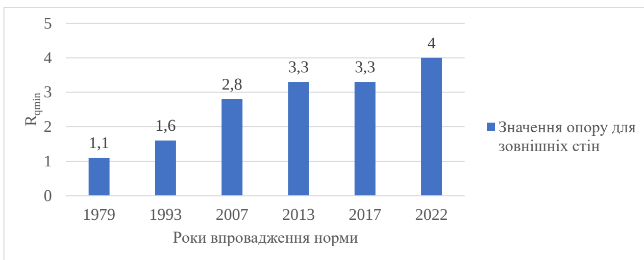
Рис. 2. Динаміка підвищення мінімально допустимого значення приведенного опору теплопередачі огорожувальних конструкцій R_{qmin} для зовнішніх стін житлових будинків в Україні
