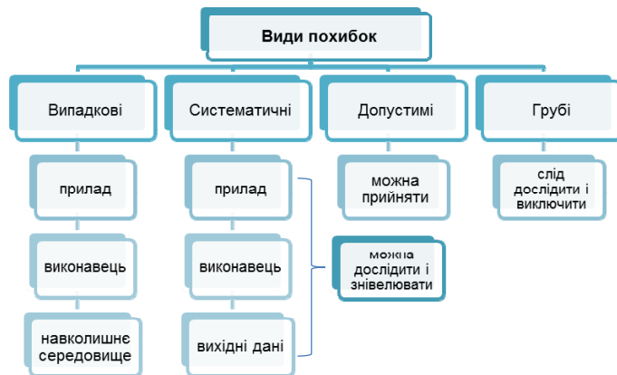
Мал. 1. Схема можливих похибок метричної інформації земельних ділянок
