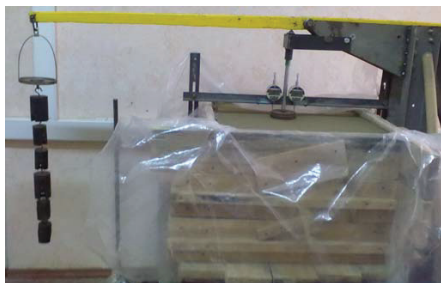
Рис. 1. Важільний прес для визначення модуля пружності ґрунту
