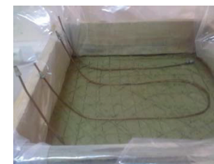
Рис. 3. Закладання мідних трубок в ґрунтову модель
