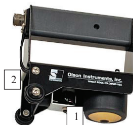
Рис. 1. Обладнання для реєстрації параметрів розповсюдження хвиль стиску при оцінці міцності цементобетонних конструкцій 1 – сейсмоприймач, 2 – ударник (генератор тестового імпульсного навантаження)
