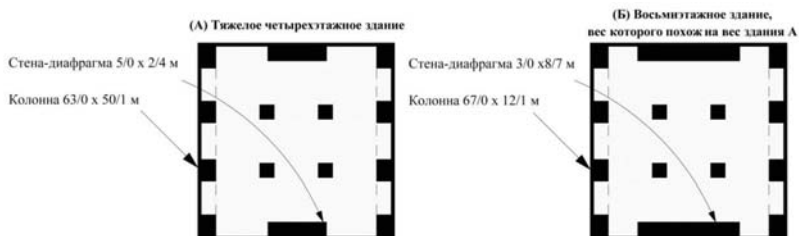
Рис.9. План цокольного этажа четырех- и восьмизэтажных зданий с одинаковым весом (система, выдерживающая тяжелые нагрузки, не показана, и рисунки изображены в одном масштабе).
