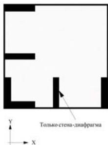
Рис.6. План цокольного этажа, который показывает сейсмостойкую конструкцию, имеющие симметричное построение относительно осей X и Y (система, выдерживающая тяжелые нагрузки, не показана).
