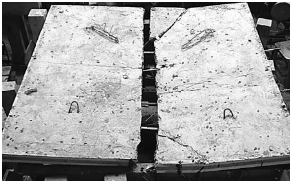
Рис.5 - Характер руйнування плити.
