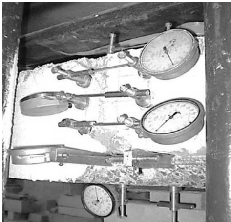
Рис. 3 - Вигляд приладів, що використовувалися для вимірювання абсолютних деформацій важкого бетону та пінобетону по висоті поперечного перерізу дослідного зразка
