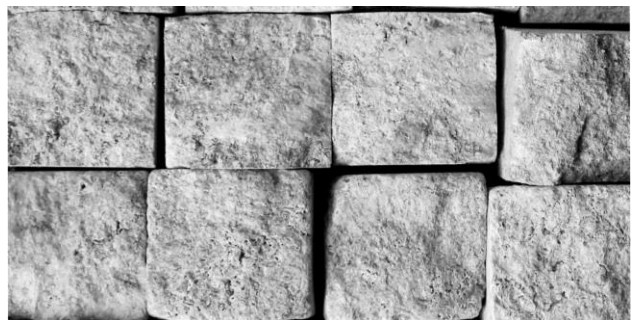
Рис. 4. Фактури бруківки: колота і колото-галтована
